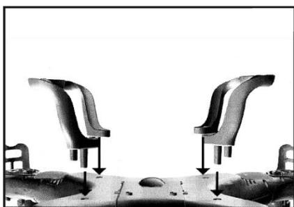
Para instalar los patines de aterrizaje en la parte inferior del dron, introduzca las cuatro clavijas del patín de aterrizaje en los orificios del dron y presiónelos.
