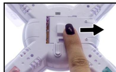
Paso 3: Abra la tapadera de la batería del dron, inserte la batería, conecte el cable y cierre la lengüeta de seguridad.
