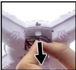
Extraiga el cable de la batería del conector de alimentación.
