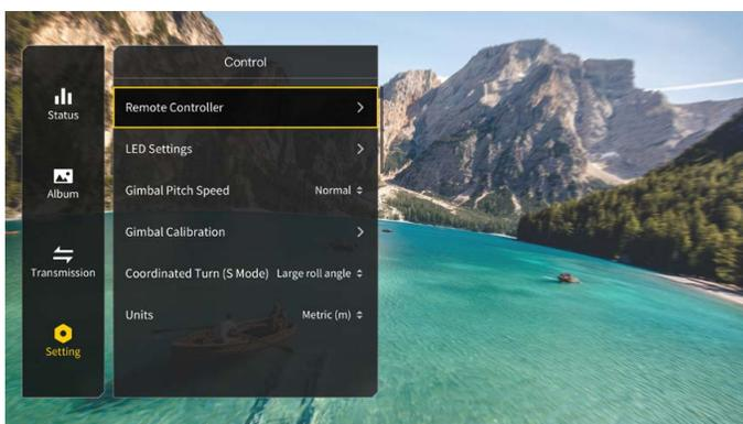
Las funciones de algunos botones del control remoto se pueden personalizar en el Control remoto. Estos incluyen el botón C1, el interruptor C2 y el modo personalizado del selector de modo de vuelo. Cuando se usa el modo manual se puede configurar el modo de palanca y ajustar el exponencial. Los usuarios también pueden calibrar el control remoto.
