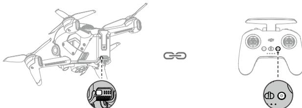
7. Una vez que la vinculación se ha realizado correctamente, el control remoto deja de emitir un pitido y los ledes de nivel de batería se iluminan y muestran el nivel de batería.
