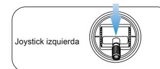
Después de las tierras de aviones no tripulados en el suelo, tirar hacia abajo la palanca del acelerador a la posición inferior y mantenga pulsado durante 3 segundos, el motor se detendrá inmediatamente. El avión no tripulado está bloqueado.
