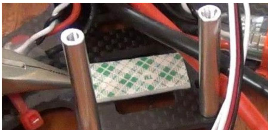
Una vez que la cinta ha sido colocada, simplemente retire la capa protectora superior y coloque su RX hacia abajo. Para una fijación óptima, puede limpiar tanto el marco como su RX con alcohol para asegurarse de que no haya aceites ni suciedad que puedan afectar la adhesión.
