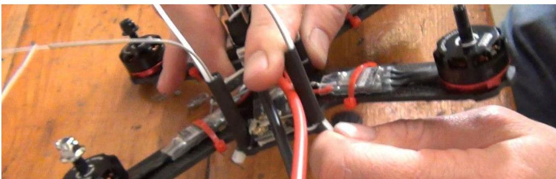
A continuación, reduzca el encogimiento de calor para asegurar tanto el cierre de cremallera como la antena al separador. Corte un poco más, el calor más pequeño se encoge y lo coloca sobre el resto de la antena:
