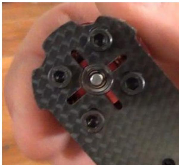
Una vez que tenga el motor centrado correctamente, es hora de apretar los pernos. Recuerde: está atornillando un perno de aluminio en una carcasa de motor de aluminio, por lo que no apriete esto como lo haría con una tuerca o un perno de cárter de aceite.
