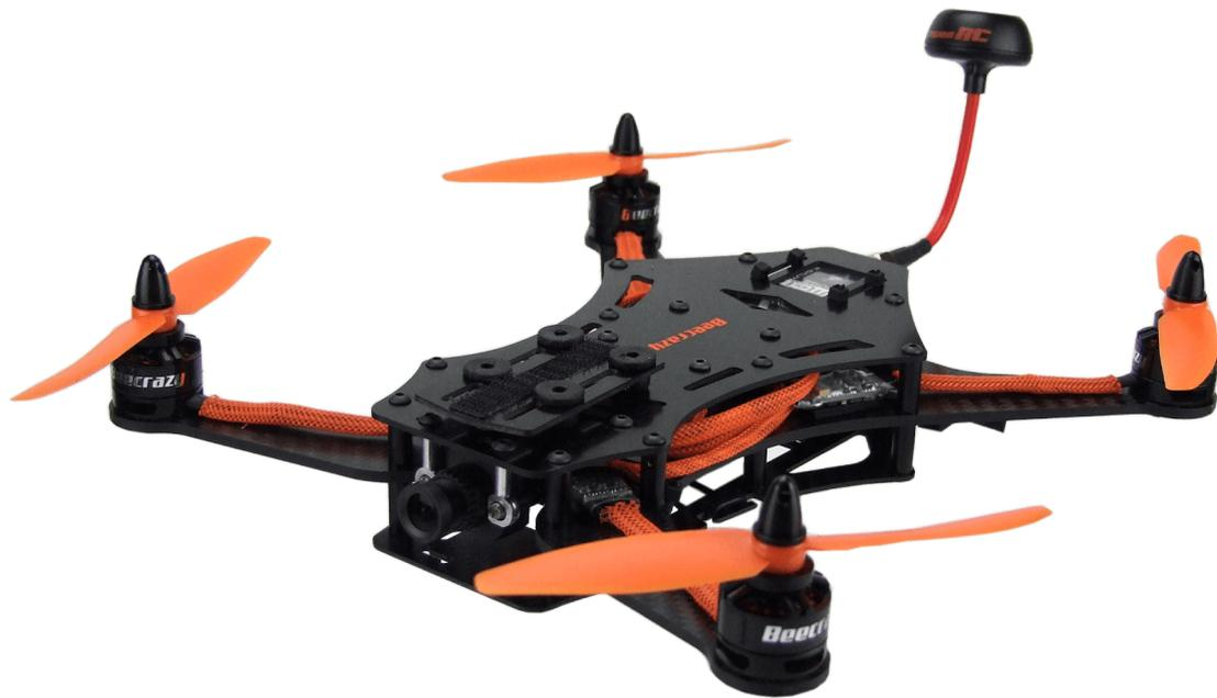
Es un pequeño quadcopter de control remoto construido para alta velocidad y agilidad. Por lo general, tienen una cámara y un sistema de transmisión de video para que puedan volar en primera persona junto a un conjunto de gafas como las vendidas por FatShark:
