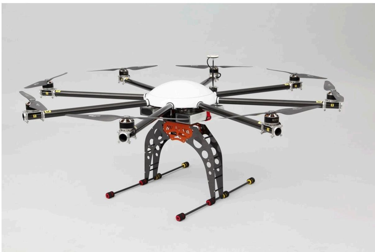
Otra ventaja de los multirrotores es que consiguen un mayor rendimiento al emplear toda la potencia del motor en crear sustentación, ya que compensan el efecto par y obtienen control de guiñada mediante el empleado de rotores contrarrotatorios. Los helicópteros, por el contrario, emplean de un 5% a un 15% de su energía en mover el rotor antipar.
